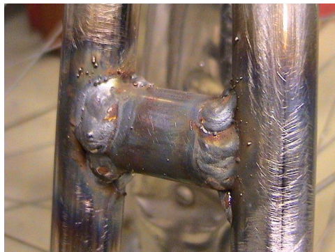
lopun väliputket mitataan ja hitsataan ympäri
